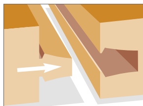
2. Man unterscheidet generell leimfreie Verlegesysteme mit oder ohne Werkzeugeinsatz. Dieses hier wird mittels Hammer und Schlagklotz ineinandergeschlagen.
