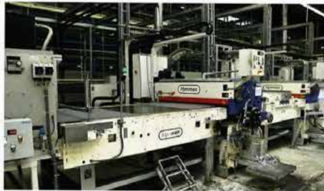
Wiparquet-Mutter Classen produziert die PVC-freien, digital direkt bedruckten (im Bild) Wand- und Bodenbeläge mit Polypropylen und Steinmehl auf Doppelbandpressen in Kaisersesch.
